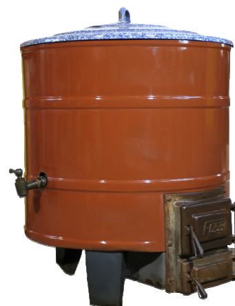
Photographie- Poêle chauffe-eau pour la lessive Collection du Musée les Mineurs Wendel
